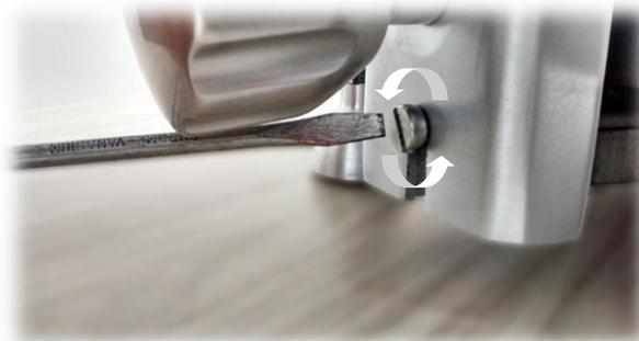
*Obs.: Não é necessário desparafusar todo o parafuso de fixação do carro para retirá-lo do cortador.*
