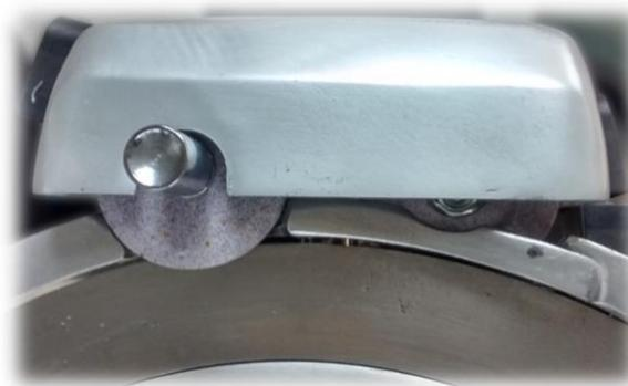
*Obs.: antes de afiar a lâmina do cortador recomendamos a limpeza da lâmina para não engordurar os discos de esmeril.*
